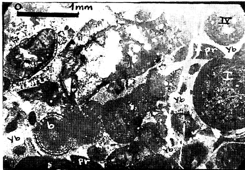
İstiflenmiş biyo-oomikrit. Şekil 3'ün II ne faz (b) de belirtilen onkolitik oolit b ile, I ne fazda belirtilen onkolit (I) ile, IV ne fazda belirtilen tane de (IV) gösterilmiştir. Numunedeki sıkılaşma ile parçalanan onkolitik oolit parçaları (pr), yeniden biçimlenme sparikalisiti (yb) ile işaretlenmiştir. Tane destekli fasiyes, RII-3.13.
